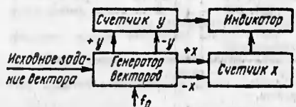
Рис. 1. Вариант структуры устройства отображения графической информации с использованием генератора векторов: f_0 — опорная импульсная последовательность
