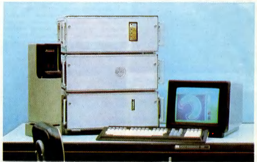
Рис. 2. Тепловизионная пирометрическая система ИИ-42ТМ
