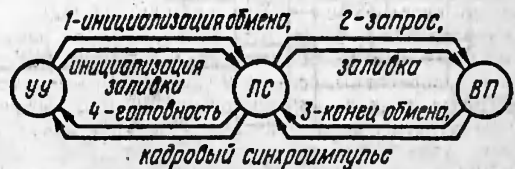
Рис. 5. Синхронизация компонентов ГК
